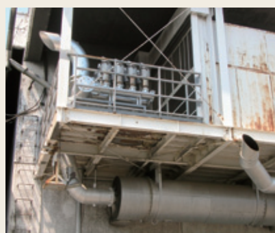
大型エンジンテストベンチ (酸化触媒付)
