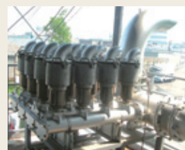
大型エンジンテストベンチ (酸化触媒付)
